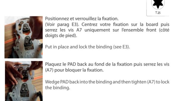
Positionnez et verrouillez la fixation. (Voir parag E3). Centrez votre fixation sur la board puis serrez les vis A7 uniquement sur l'ensemble front (côté doigts de pied).
